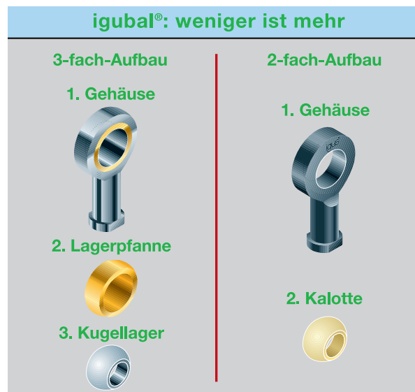
Grafik 200.4: Overmolding macht möglich: Sphärische Lager aus nur zwei Bauelementen
