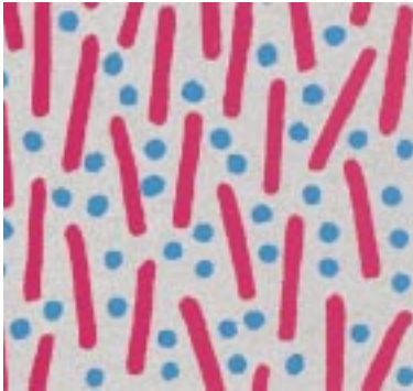
Grafik 200.6: Der Aufbau von iglidur®: Basispolymer, Füllstoffe und Festschmierstoffe
