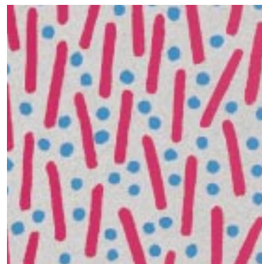
Grafik 200.9: Der Aufbau von iglidur®: Basispolymer, Füllstoffe und Festschmierstoffe
