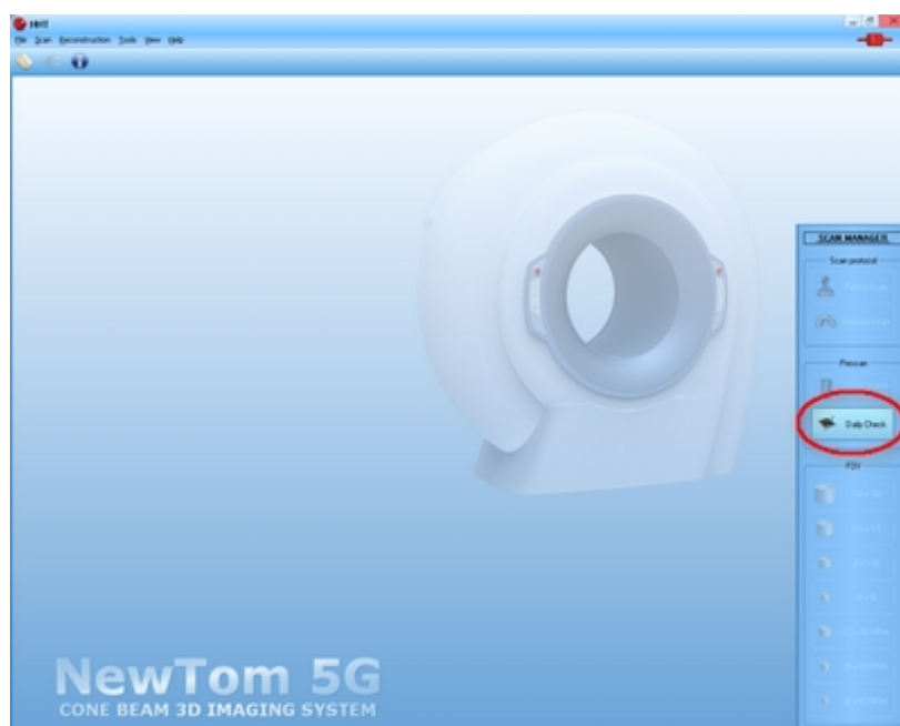
Widok ekranu z prośbą o wykonanie kontroli codziennej
